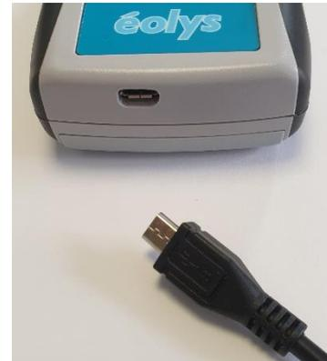
Note : il faut connecter le câble à l'ECG en mettant la partie marquée « B » en-dessous.
