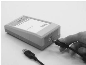
**Après** avoir installé les pilotes de périphériques et l'application, connectez le câble USB au périphérique et au PC.
