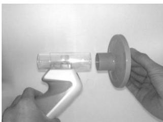
Connectez le filtre antibactérien et antiviral à l'extrémité de plus grand diamètre du capteur Pink-Flow.
