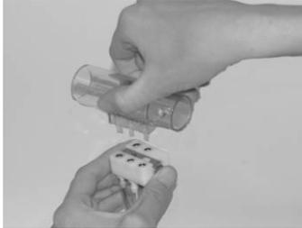
Connectez le capteur PinkFlow au connecteur rapide pneumatique. Pour le retrait, appuyez sur le bouton métallique.
