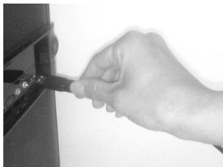
**Après** avoir installé les pilotes de périphériques et l'application, connectez le câble USB au PC.
