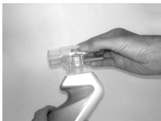
Pour la connexion, poussez le capteur PinkFlow sur le connecteur rapide.
