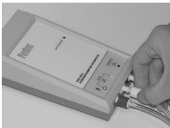
Connectez le connecteur bleu du tube jumeau à la prise codée bleue indiquée par l'étiquette du capteur et le connecteur blanc à la prise codée blanche. Pour la bonne connexion, la fixation doit être tournée à 180 degrés dans le sens des aiguilles d'une montre.
